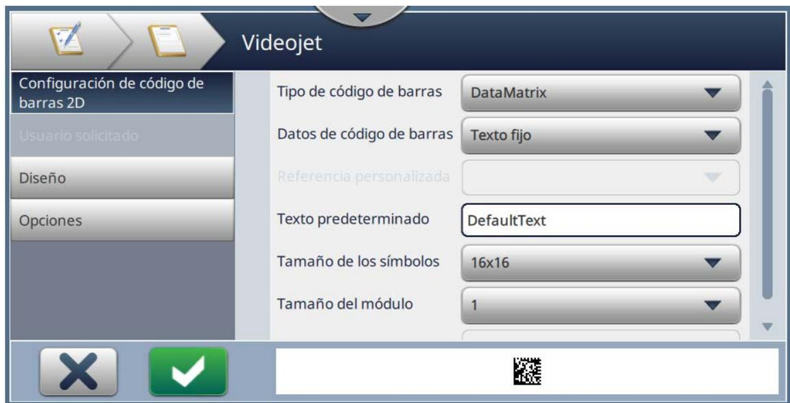
Figura 6-10: Pantalla Configuración de código de barras 2D
