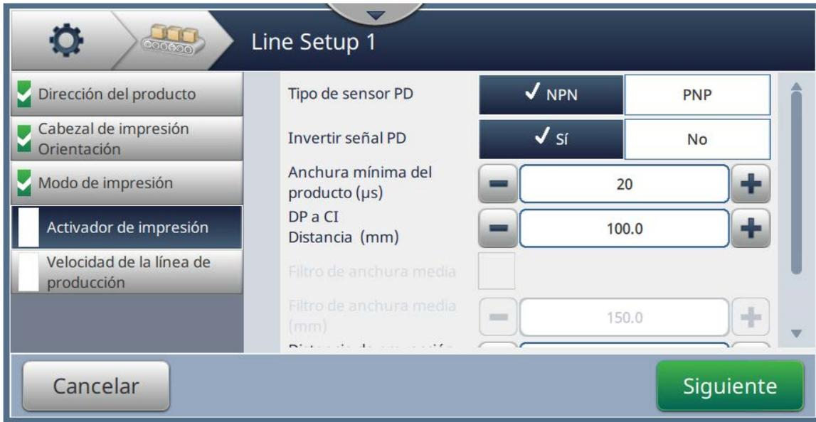
Figura 6-34: Configuración de línea: Activador de impresión
