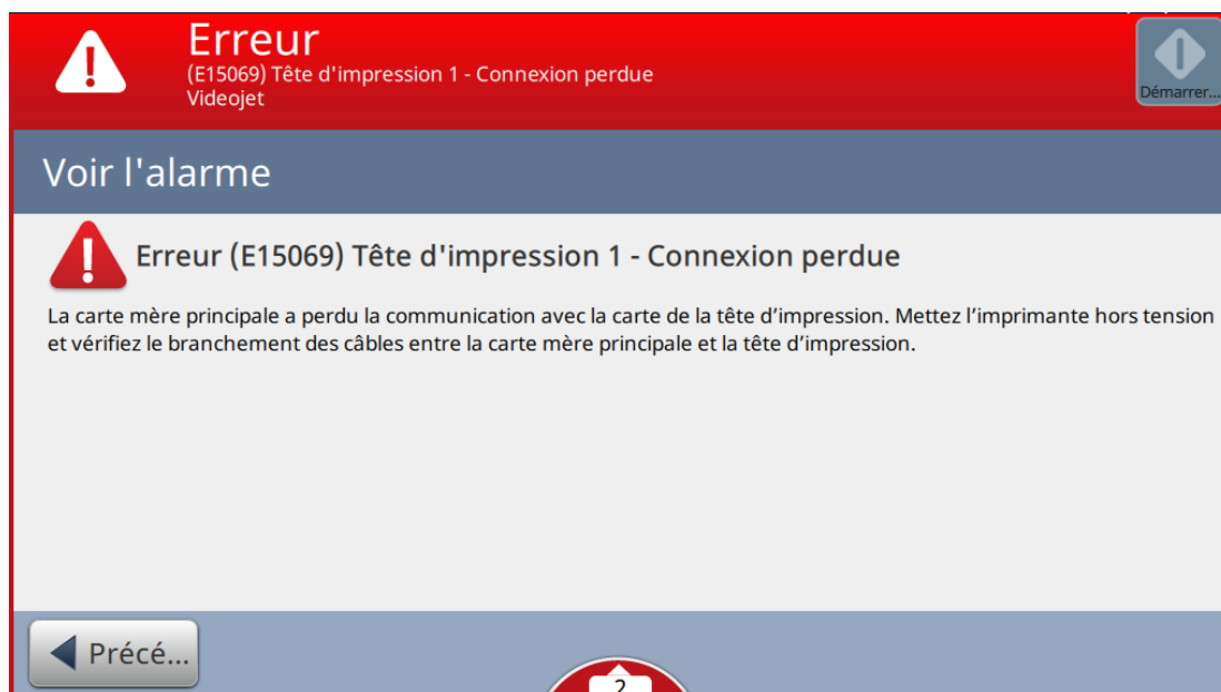
Figure 8-8 : Affichage des détails des anomalies
