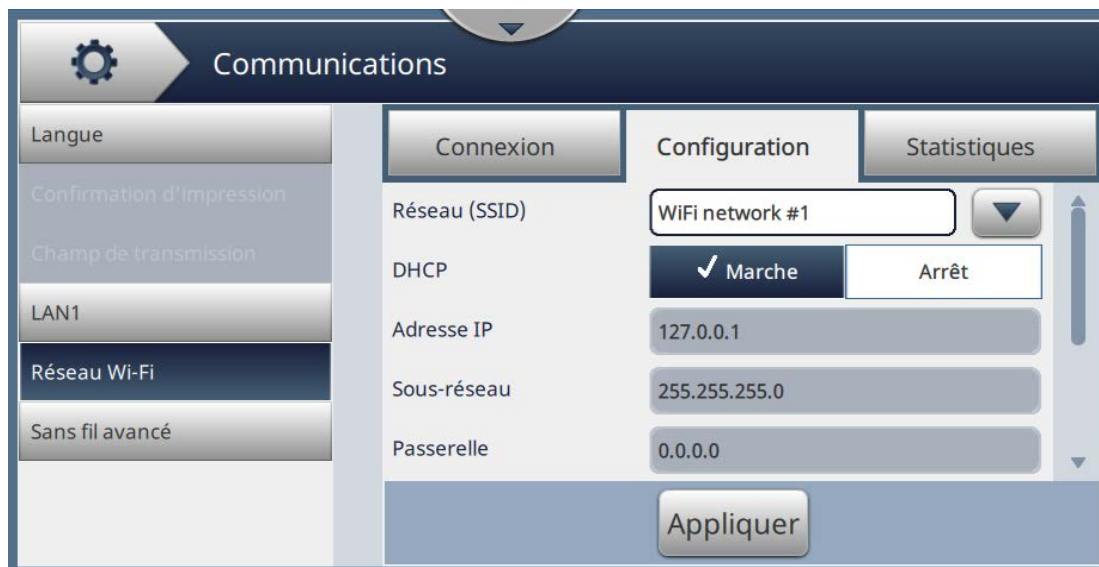
Figure C-2 : Communications - Réseau Wi-Fi
