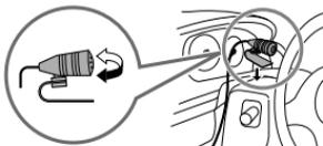
Asegúrelo mediante abrazaderas para cable (no suministradas) si fuera necesario.
