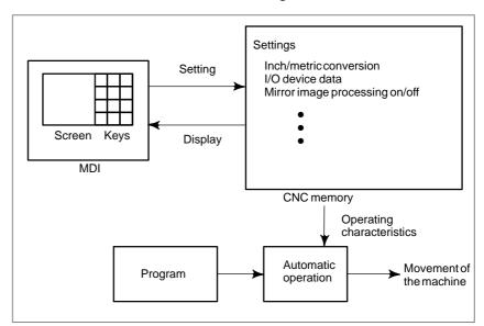
Fig.1.6 (d) Displaying and Setting Settings
