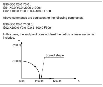
Fig.12.5 (d) Scaling for circular interpolation 2
