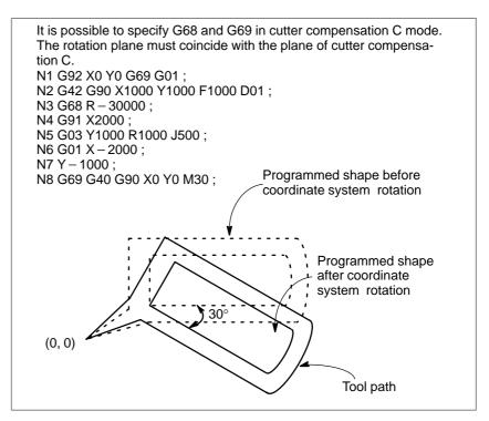
Fig.12.6 (d) Cutter compensation C and coordinate system rotation
