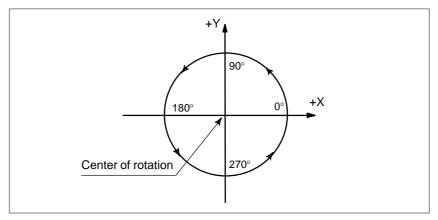
Fig.12.7 (d) Angle of the C axis
