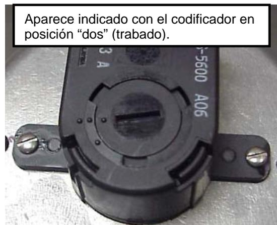
3. Inserte una llave hexagonal (que le fue suministrada con el nuevo codificador) dentro del puerto de acceso y haga girar el motor hasta que encuentre el tornillo de ajuste. Afloje el tornillo de ajuste.
