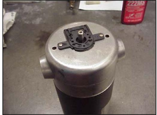
7. Alinee el eje del motor con la placa base tal como se indica en la foto. Esto asegura que la parte plana del eje del motor esté en la posición adecuada para ajustar el tornillo de ajuste del eje.
