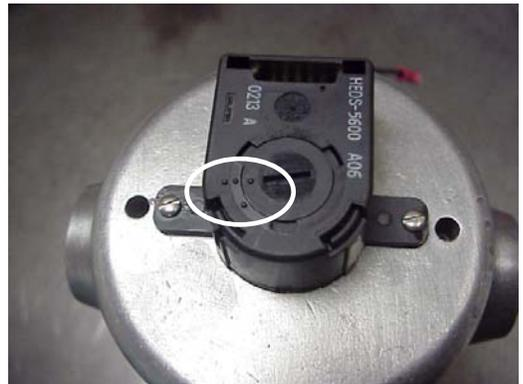
11. Conecte la conexión eléctrica al codificador (que se quitó en el paso 2) y monte la cubierta de vinílico del codificador.
